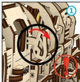
**UKR** Опустіть спусковий важіль 1. **ENG** Lower the trigger lever 1. **DEU** Lassen Sie den Aufzugshebel herunter 1. **FRA** Abaissez le levier de détente 1. **POL** Opuść dźwignię spustową 1. **SPA** Baje el manubrio de puesta en marcha 1. **ITA** Abbassare la leva di avvio. **TUR** Çalıştırma kolunu indiriniz 1. **RUS** Опустите спусковой рычаг 1.
